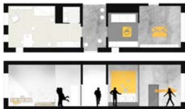
Figur 104: Et eksempel på placering af boligunderstøttende fællesarealer, der hvor beboerne alligevel færdes på vej ind og ud af bygningen. Herved understøttes den potentielle kontakt mellem beboerne og derved fællesskabet. Eksemplet viser ankomstområdet i den almene del af Siloen i Aalborg, som er kombineret med vaskerum og postrum. Det gør, at beboerne opfatter rummet som et vigtigt sted for fællesskab. © C.F. Møller Architects.
